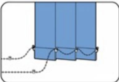
L'ouverture doit toujours se faire avec les bandes orientées perpendiculairement au rail.
